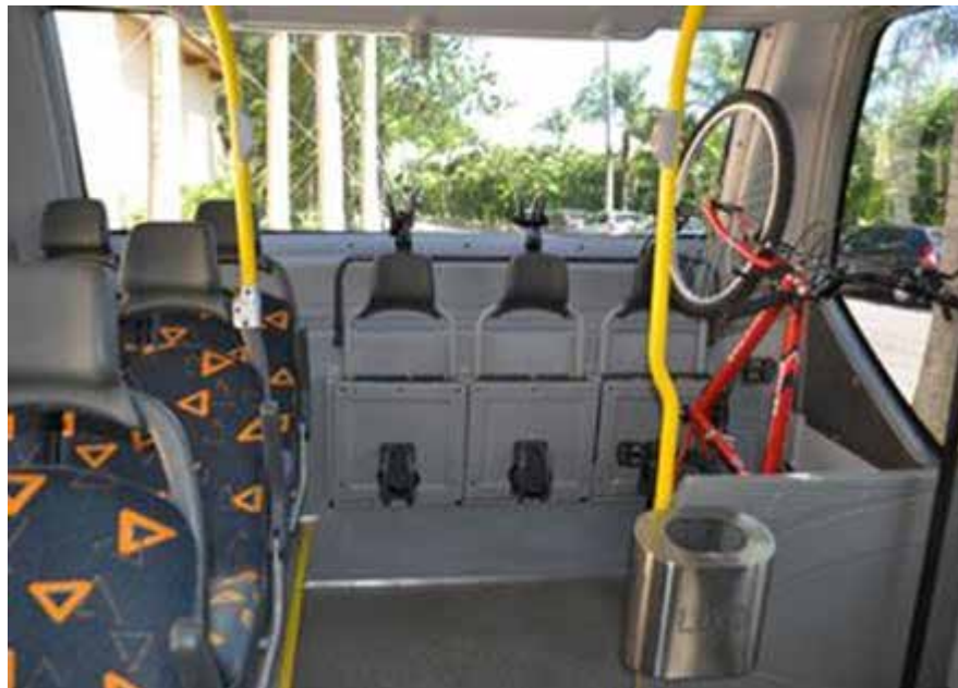
312 ÁREA INTERNA PARA BIKE EM BUS FONTE: NEOBUS
