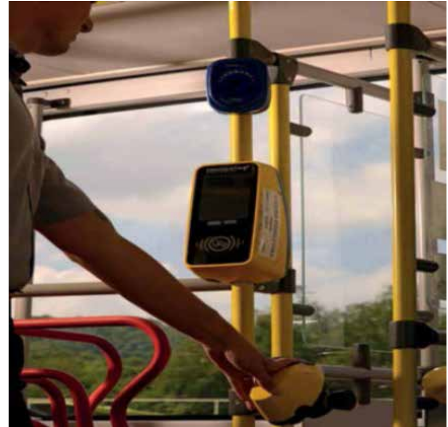
247 MODELO DE LEITOR PARA BILHETAGEM ELETRÔNICA, COM CÂMERA PARA FUNÇÃO DE BIOMETRIA. Fonte: FETRANSPOR (2016)
